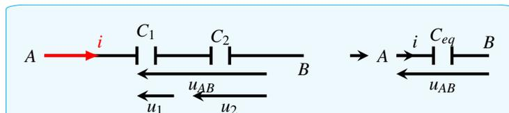
La capacité équivalente C du condensateur équivalent de l'association en série de deux condensateurs de capacités C<sub>1</sub> et C<sub>2</sub> est telle que
