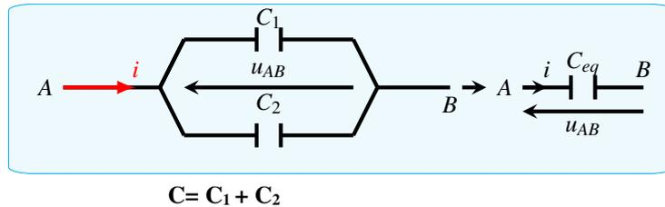
La capacité équivalente C du condensateur équivalent de l'association en parallèle de deux condensateurs est égale à la somme de leurs capacités C<sub>1</sub> et C<sub>2</sub>.
